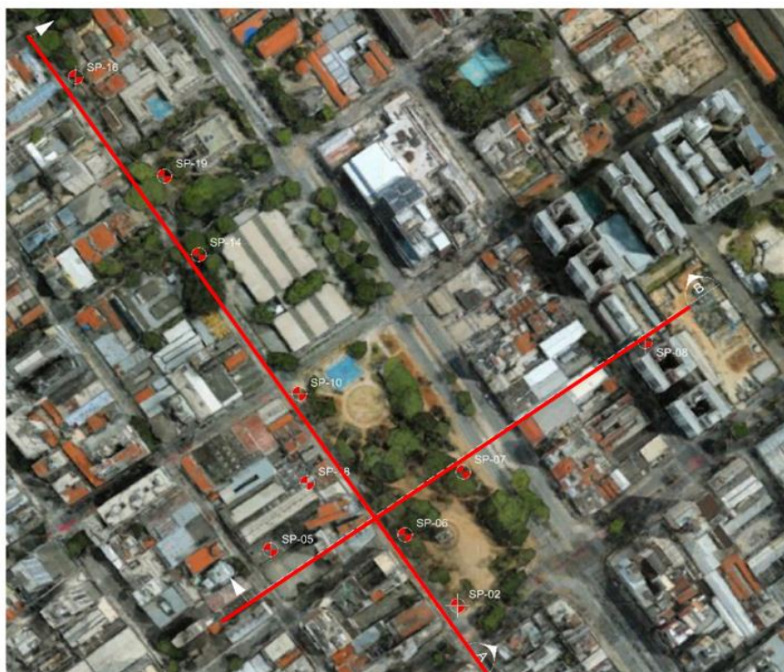
Figura 5 - Locação dos Perfis Geológico-Geotécnicos Traçados e as Sondagens de Referência
